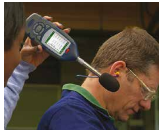
Piccolo e leggero con display luminoso a colori, il 63X semplifica le misurazioni del rumore sul luogo di lavoro
