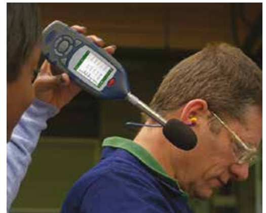
El 63X, pequeño y ligero con clara pantalla de color, facilita las mediciones del ruido en el entorno laboral
