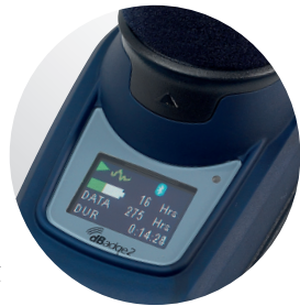
智能显示屏显示电池剩余使用时间和内存容量
